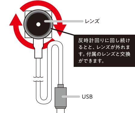
ピント合わせは手動で行います。レンズカバー部分を回して被写体に合わせて回転させて調整します。周囲の明るさが足りない場合もピントが合いづらくなります。
