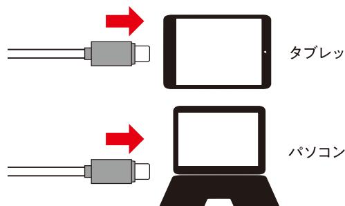
パソコン、スマートフォン、タブレットのUSBにカメラのUSBを接続します。端末側にUSB typeC端子がない場合は付属のUSBアダプタを使用して接続して下さい。各対応のアプリケーションを起動させて下さい。使い方は各アプリケーションの説明書をご確認下さい。
