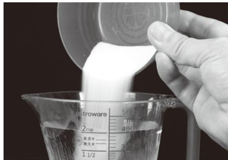
40gの塩を量ります。※付属のスプーン5杯(すり切り)で約40gです。400mlの水に塩を加え、軽くかき混ぜます。(海水でも使用できます。通常の食塩水を使用する場合より、発電能力は低下いたします)
