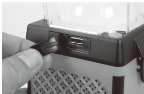
スイッチを押すとライトが点灯します。2段階に明るさを調整できます。ランプが点灯していないときにUSBケーブルを接続すると機器への充電がきます。
